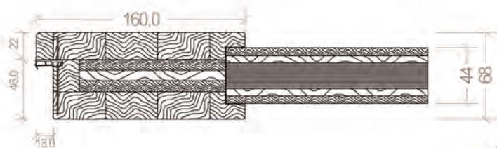
Rahmenstärke ca. 68 mm, Rahmen außen 160 mm aus Leimholz und 3-Schichtplatte eckig. Die Füllung ist glatt aus 20 mm Gips mit 12 mm Holz-Aufdoppelung.
