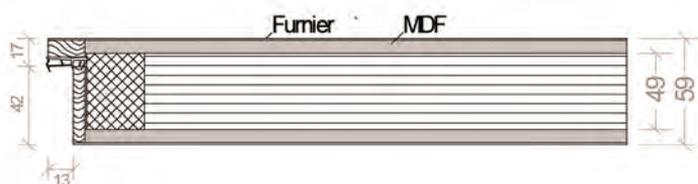
Türstärke ca. 59 mm, Aufbau 5-fach, Brandschutzmittellage mit Stabilisator, Massivholzanleimer plus Deck aus MDF mit Starkfurnier, Klima 3, Dämmschichtbildner verdeckt im 42 x 13 mm Falz eckig gefast, Marken-PZ-Schloss Stulp Nirosta, Dorn 65 mm, 2x Bänder VX 7939/160 Edelstahl, Schall-Ex, Scherentriebschließer und schwarzer Kunststoffdrücker beigelegt
